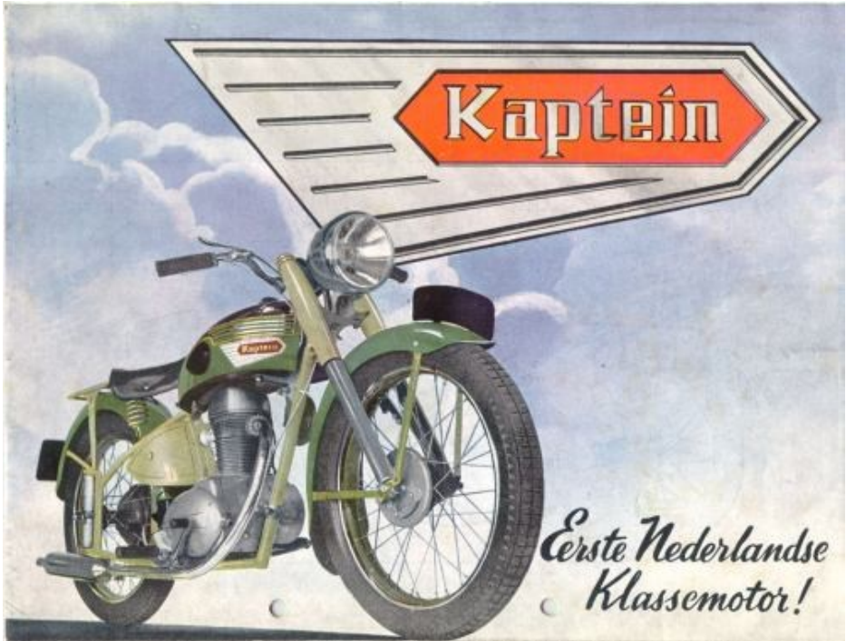
De Kaptein 175 cc kopklepper, gefabriceerd van 1949—1951 in Arnhem. Deze motor is een in licentie gebouwde Motobécane Z2C. Hoeveel zullen er zijn overgebleven ?
