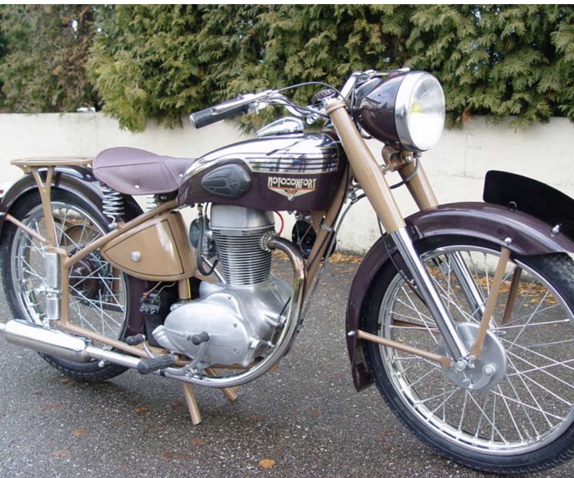
Motobécane Z2C of MotoConfort U2C , 175 cc kopklepper, voor het eerst in 1949 op de markt gebracht. Werd ook door Willem Kaptein in Nederland gefabriceerd onder naam "Kaptein".
